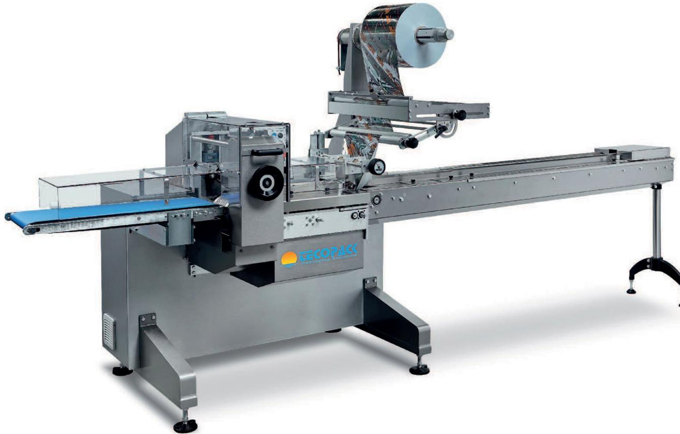
Confezionatrice orizzontale a tre assi elettrici brushless studiata appositamente per applicazioni con caricamento manuale dei prodotti, con gli stessi punti di forza delle macchine Tecopack di alta gamma: esecuzione a sbalzo; touch screen a colori da 7 pollici con interfaccia intuitiva; completo accesso all'area operativa della macchina.
